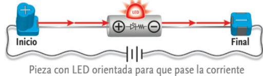
Pieza con LED orientada para que pase la corriente
