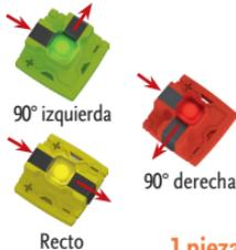
**3 piezas con LED** (1 roja, 1 amarilla y 1 verde). Cada pieza contiene una resistencia para limitar el flujo de corriente y un LED (Light Emitting Diode o diodo emisor de luz) que se enciende cuando pasa la corriente por él en la dirección correcta.
