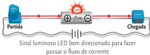
O diagrama a seguir mostra que se o LED está montado no sentido contrário, ou seja, o polo negativo (-) está virado na direção do ponto de Partida (+), a válvula fecha e o fluxo de corrente é interrompido. Nesse caso o LED não ilumina-se.
